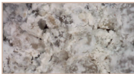
↑ Obr. P09: Vzhled omítky, zvětšeno 150x Foto: ČVUT, 2023
