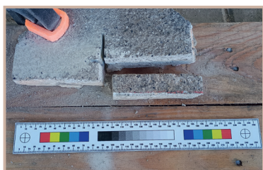
↑ Obr. 6: Úprava odebraného vzorku na menší vzorkové sady k dalším analýzám. Foto: VŠTE, 2023
