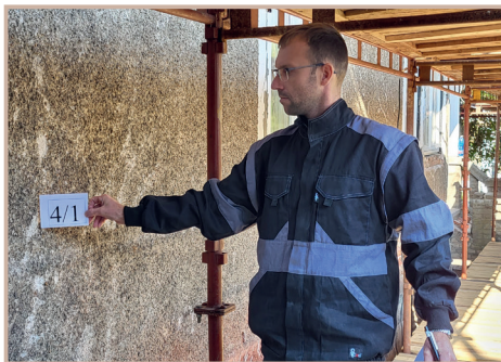
↑ Obr. 5: Tábor, Laudova ulice, dům čp. 1273/19, identifikace a fotodokumentace místa odběru včetně označení vzorku. Foto: VŠTE, 2023
