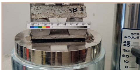
↑ Obr. 7: Testování upraveného vzorku za účelem zjištění pevnostních charakteristik. Foto: VŠTE, 2023
