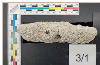
↑ Obr. P06: Průřez omítkou.
